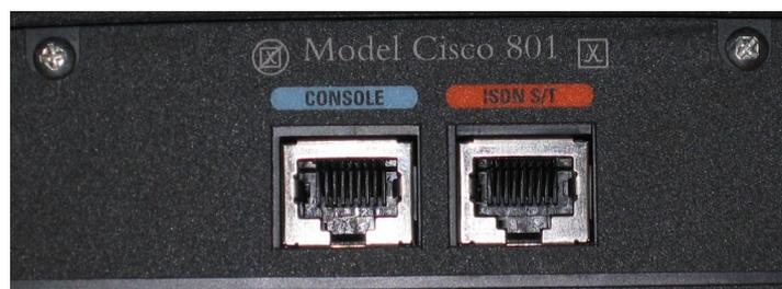
In der Abbildung ist zu erkennen, dass es sich um ein S/T-Interface handelt. So kann der Router direkt an einen NT1 angeschlossen werden, da er über ein eigenes ISDN-Interface verfügt.
